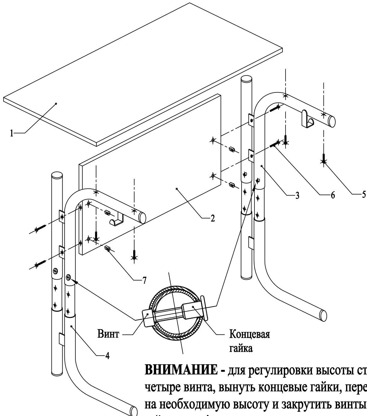
**ВНИМАНИЕ** - для регулировки высоты стола выкрутить четыре винта, вынуть концевые гайки, переместить опоры на необходимую высоту и закрутить винты и концевые гайки вновь!
